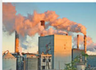
4.9 La lluvia ácida se produce por la emisión de gases de dióxido de azufre y óxidos de nitrógeno que al combinarse con el agua generan ácidos.
