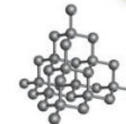
2.57 El diamante tiene un punto de fusión de 3 550 °C, es insoluble en agua y no conduce corriente eléctrica. Además es un material extremadamente duro, por lo que se utiliza para fabricar herramientas para corte, lijado y pulido de materiales como el concreto.
