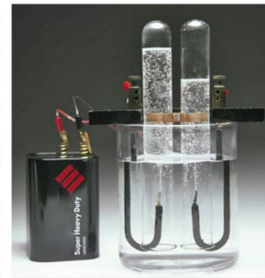
2.1 Descomposición electrolítica del agua.
