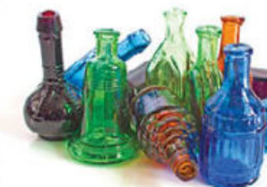
4.19 Algunos óxidos de metales de transición se usan en la manufactura del vidrio para brindarle color y mejorar su apariencia estética. Por ejemplo, el óxido de cobre, en pequeñas proporciones, produce el color turquesa y el óxido de hierro (III) permite obtener el color verde de las botellas de cerveza.
