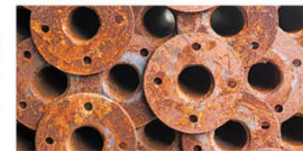
3.4 En la segunda imagen no es que el hierro se haya vuelto rojo, sino que al reaccionar con el oxígeno del aire se obtuvo otra sustancia: el óxido de hierro, un polvo que es de ese color.
