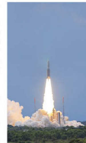
4.25 El oxígeno del aire es el comburente usado en la mayoría de los motores de reacción de aviones, sin embargo, cuando la disponibilidad de oxígeno es insuficiente, como ocurre con los cohetes que viajan al espacio en donde no hay aire, es necesario equiparlos con tanques de este elemento en su forma gaseosa o líquida.
