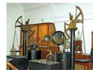
1.39 Aparato utilizado por Lavoisier para medir la masa de los gases involucrados en la combustión.
