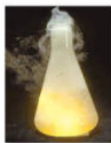
3.11 El momento de la formación de cloruro de sodio (sal común) a partir de sodio metálico y cloro molecular es un ejemplo de reacción exotérmica.
