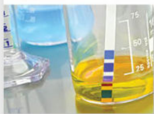
4.11 Al humedecer una tira de papel pH en una disolución, ésta cambiará de color de acuerdo con su acidez o basicidad.
